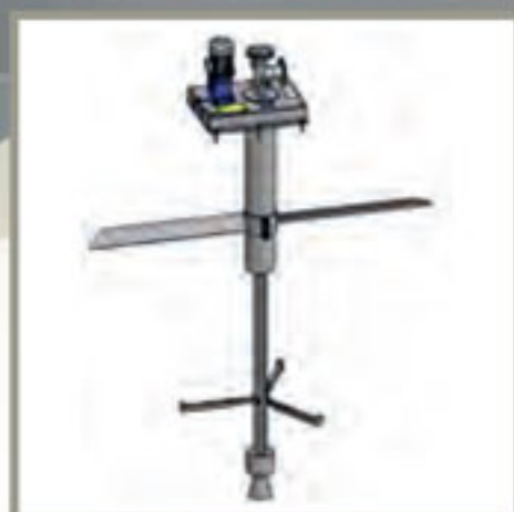
DP Dissabbiatore a pista Sand trap "pista" type
