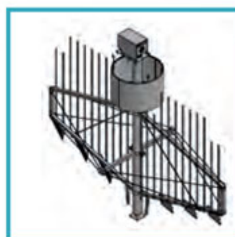
ISP Ispessitore fanghi Sludge thickner
